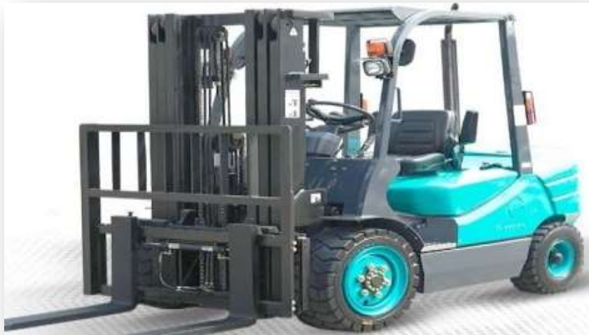
(25) – FORKLİFT 3 TON – DİESEL / ÜRETİM İÇİN h: 4,20 mt.
